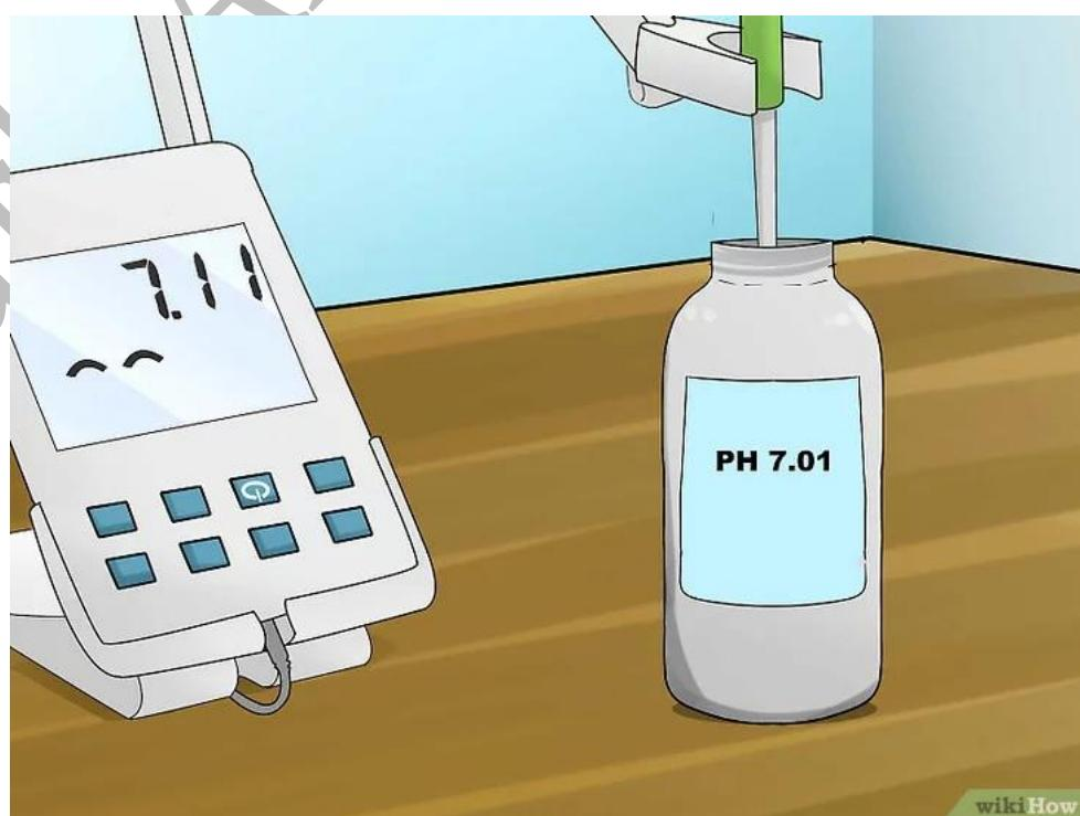
اضبط الأُس الهيدروجيني: اضبط المقياس على قيمة الأُس الهيدروجيني للمحلول المنظم بعدأخذ قراءة ثابتة عن طريق ضغط زر القياس مرة أخرى، سيمكنك ضبط مقياس الأُس الهيدروجيني بعد استقرار القراءة من أخذ قراءة أكثر دقة وصححة.
