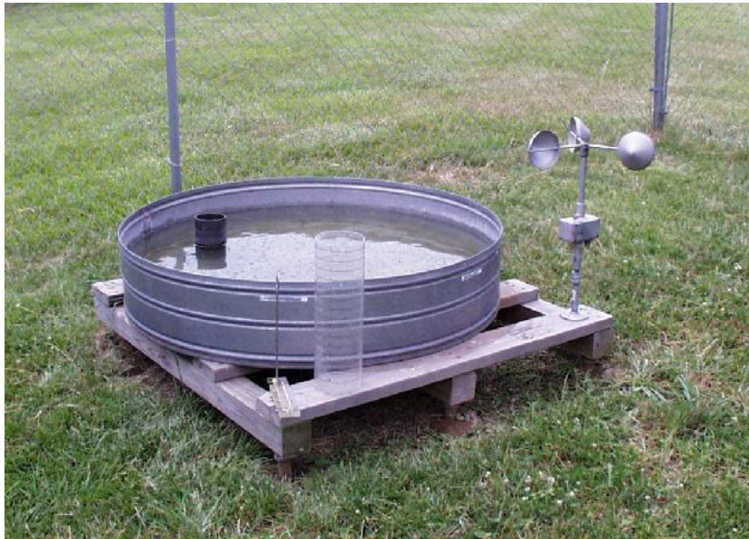
شكل (٦) صورة توضح وعاء البخر التراكمي لجدولة الري
