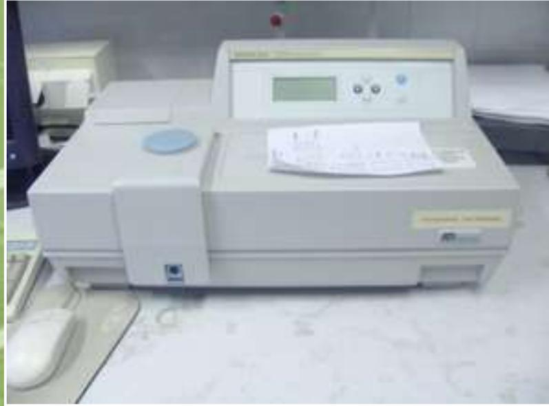
► **السبكتروفوتومتر** هو جهاز لقياس كمية الضوء للمادة المستعملة عن طريق طول الموجة التي توجه للجهاز.
