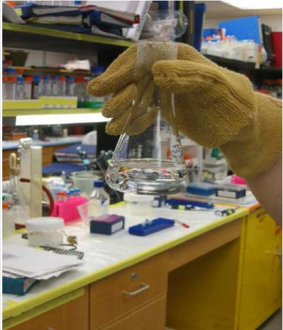
• يسخن الدورق في المايكرويف عند الحاجة حتى يذوب المسحوق بالكامل في الماء .
