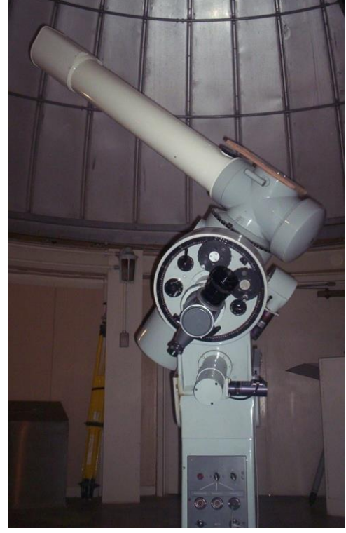
شكل 2-3: (يمين) تلسكوب كاسر 15سم، (يسار) تلسكوب عاكس 45 سم (مرصد جامعة الملك سعود)
