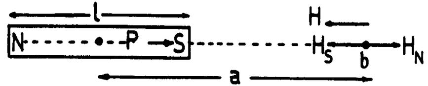
شكل (٣-٤) : حساب المجال المغناطيسي لمغناطيس دائم عند نقطة
