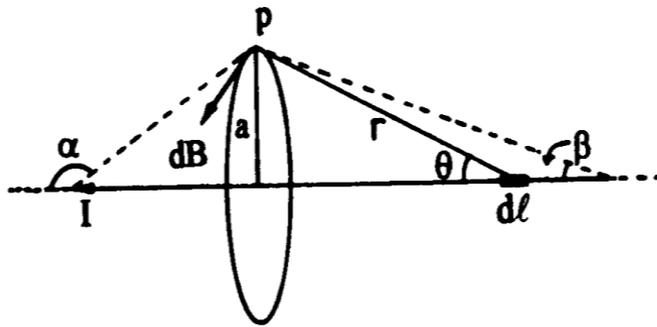
توضيح لحساب الحث المغناطيسي عند النقطة p والناجم عن مرور تيار كهربائي في موصل مستقيم .
