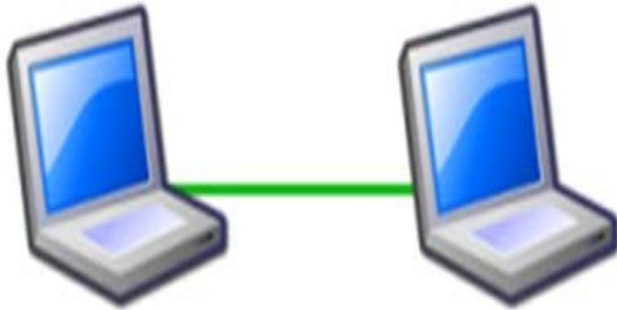
في هذا النوع من الشبكات لا يوجد خادم لذلك لا يوجد متحكم بالشبكة لكن يستطيع كل جهاز في الشبكة الاستفادة من موارد الجهاز الآخر سواء المكونات المادية أو البرمجية, وتستخدم هذه الشبكات في الشركات لنقل الملفات أو المستندات من جهاز إلى آخر, كما يستخدم هذا النوع بكثرة في مقاهي الإنترنت وذلك للمشاركة في خط هاتفي واحد, يكفي نظام تشغيل بسيط لإدخال الأجهزة على هذا النوع من الشبكات.
