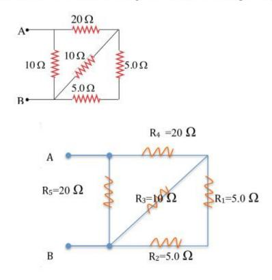
$R_1=5\Omega$ ,  $R_2=5\Omega$ ,  $R_3=10\Omega$ ,  $R_4=20\Omega$ .  $R_5=10\Omega$
