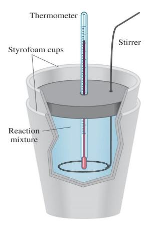
$q_{sys} = q_{water} + q_{cal} + q_{rxn}$  $q_{sys} = 0$  $q_{rxn} = -(q_{water} + q_{cal})$  $q_{water} = m \times s \times \Delta t$
