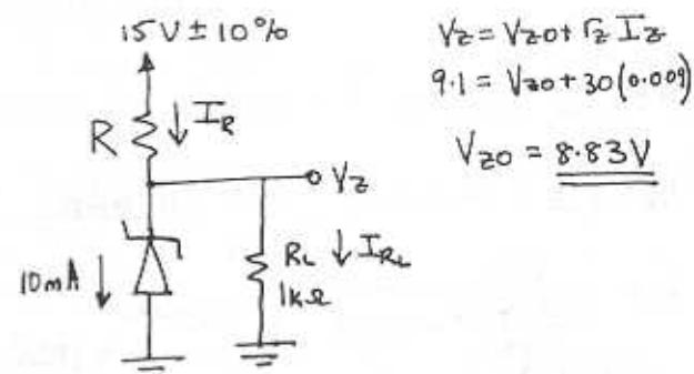
$$V_z = V_{z0} + r_2 I_{zT}$$
