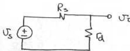
SMALL SIGNAL EQUIVALENT CIRCUIT
