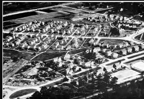
Abb. 21: Radburn, Luftbild 1929. Mehrere Superblocks (Häusergruppen um einen cul de sac) fassen eine öffentliche, verkehrsberuhigte Grünfläche ein.
