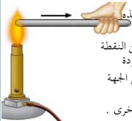
هو انتقال الحرارة عن طريق تبادل الطاقة الحرارية بين جزيئات الوسط دون انتقال لهذه الجزيئات.
