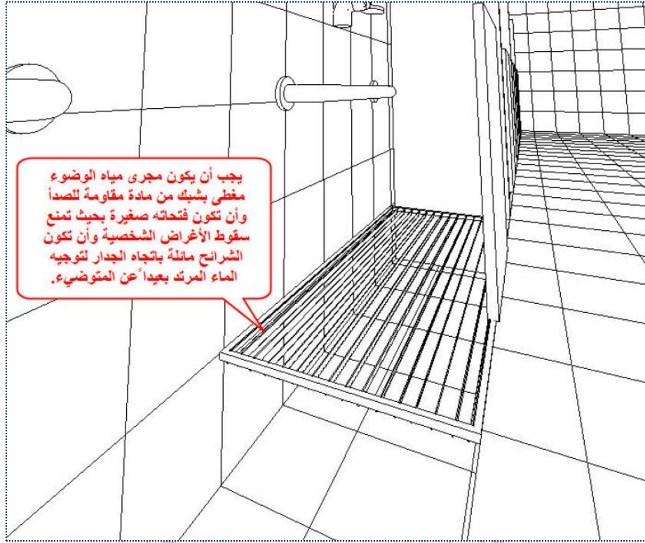
شكل (٤-٢٥)، تفاصيل المواد المستخدمة في مجري جميع المياه في دورات المياه والمواضي. المصدر: الموسى، ٢٠١٧م
