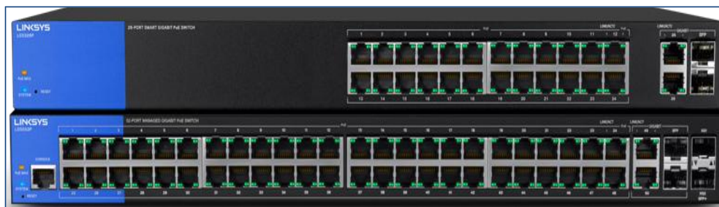
وحدة التوصيل المركزية Switch
