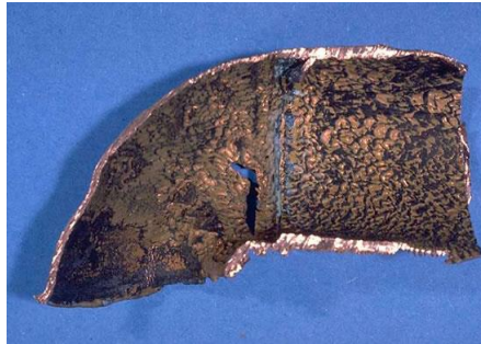
www.cdcorrosion.com شكل (٢٨) التآكل بالتعرية (Erosion corrosion)
