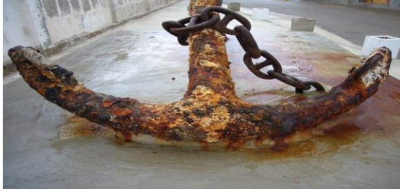
شكل (١٩) التآكل الرطب Wet Corrosion
