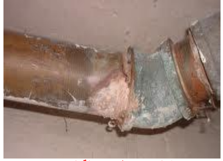
http://www.sailnet.com شكل (٢٧) ظاهرة إزالة الخارصين (De-zincification)
