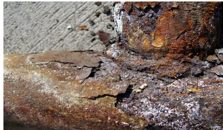
شكل (٢٦) التقصف الهيدروجيني Hydrogen Embrittlement
