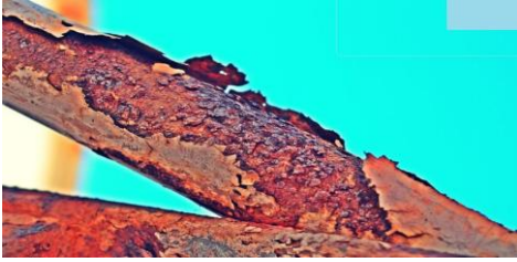
شكل (٢) تآكل الحديد (خاصية الصدأ)
