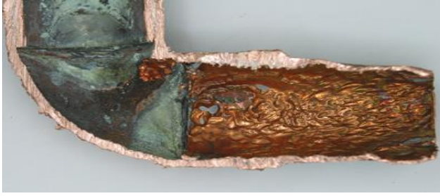
شكل (٧) تآكل النحاس و تظهر لنا الطبقة الخضراء
