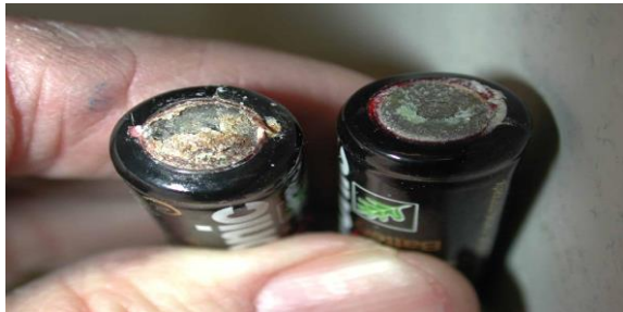
شكل (٢٠) التآكل الجاف Dry Corrosion
