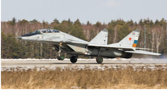
شكل (١٠) أجزاء من ميغ-٢٩ الروسية مصنوعة من سبيكة ألومنيوم سكانيديوم
