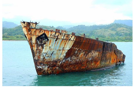
شكل (١) أحدى السفن التي قد تآكل هيكلها الخارجي بسبب تفاعل الماء و الأوكسجين الموجود في الهواء
