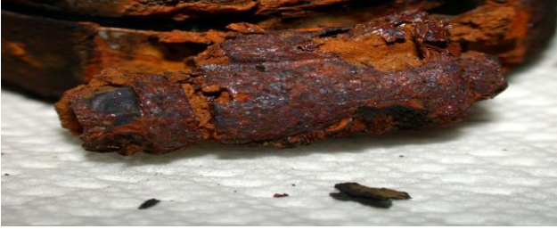
شكل (٨) تآكل الحديد و يظهر لنا الصدأ الأحمر
