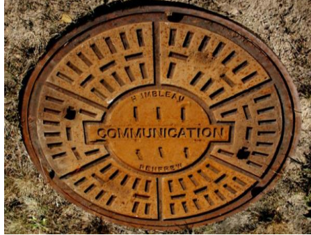
شكل (٢١) صورة للتآكل المنتظم Uniform Corrosion
