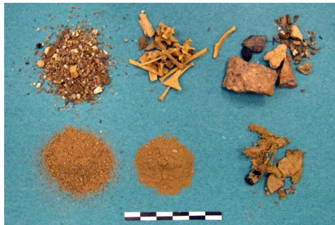
الشكل رقم (2): يوضح نتيجة التحليل المنخلي لأرضية المصطبة.
