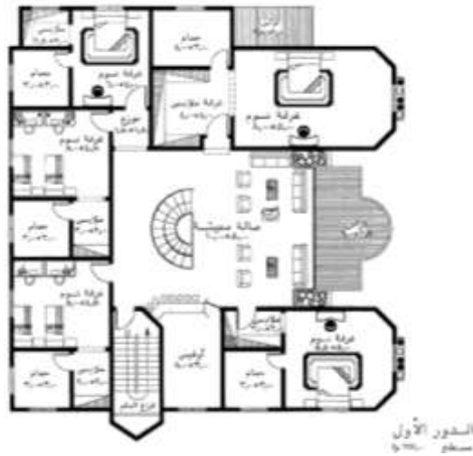
شكل (١٥): المسقط الأفقي للدور الأول لفيللا سكنية بنظام رسومات تطوير الفكرة. المصدر: موقع: المهندس محمد النوايسة. ٢١
