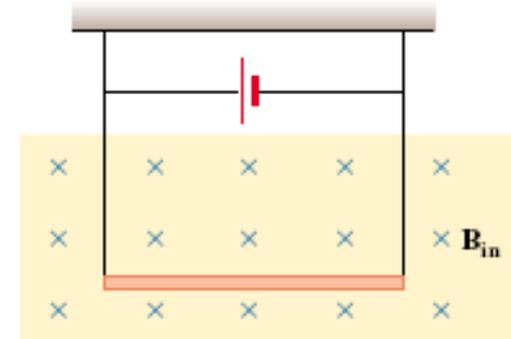
مثال ٦: موصل معلق بواسطة سلكين مرنين كما بالشكل المجاور إذا كانت كتلة وحدة الأطوال من السلك  $0.04\text{kg/m}$  فما هي قيمة واتجاه التيار اللازم مرورها بالسلك حتى تكون قيمة الشد بسلكي التعليق تساوي صفر عندما يكون قيمة المجال المغناطيسي  $3.6\text{T}$  وداخل إلى الصفحة.
