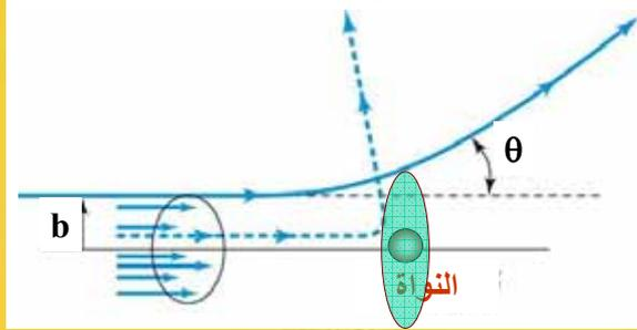
والمساحة المحيطة بالنواة  $\pi b^2$  تسمى بمساحة مقطع (cross-section) التفاعل ( $\sigma$ )
