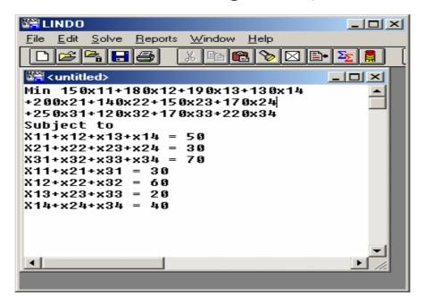
وعند التأكد من كتابة الصياغة بشكل صحيح نأتي إلى حلها بالذهاب إلى قائمة حل (solve) ثم اختيار أمر حل (Solve). وعند حلها تخرج نافذة تؤكد وجود حل أمثل (Optimal) للمشكلة من أول تشغيل وبسرعة جدا وبجزء من الثانية (Elapsed time). ونجد أن الحل الأمثل مطابق لنفس الحل الذي سبق وأن قمنا به باستخدام جداول النقل وهو (20900) ريال هي أقل تكلفة ممكنة:
