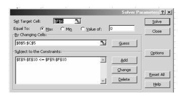
ومن Options ستظهر نافذة أخرى Solver Options نختار Assume linear Model ثم. Assume linear Model ثم. Solver Options من نافذة Solver Parameter اختر Solver اختر عليه النتائج النهائية:
