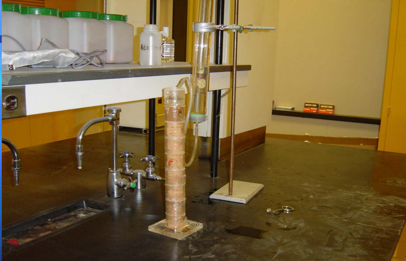
الصورة ١. جهاز الغمر المستخدم في تقدير معدل التسرب في معمل فيزياء التربة .
