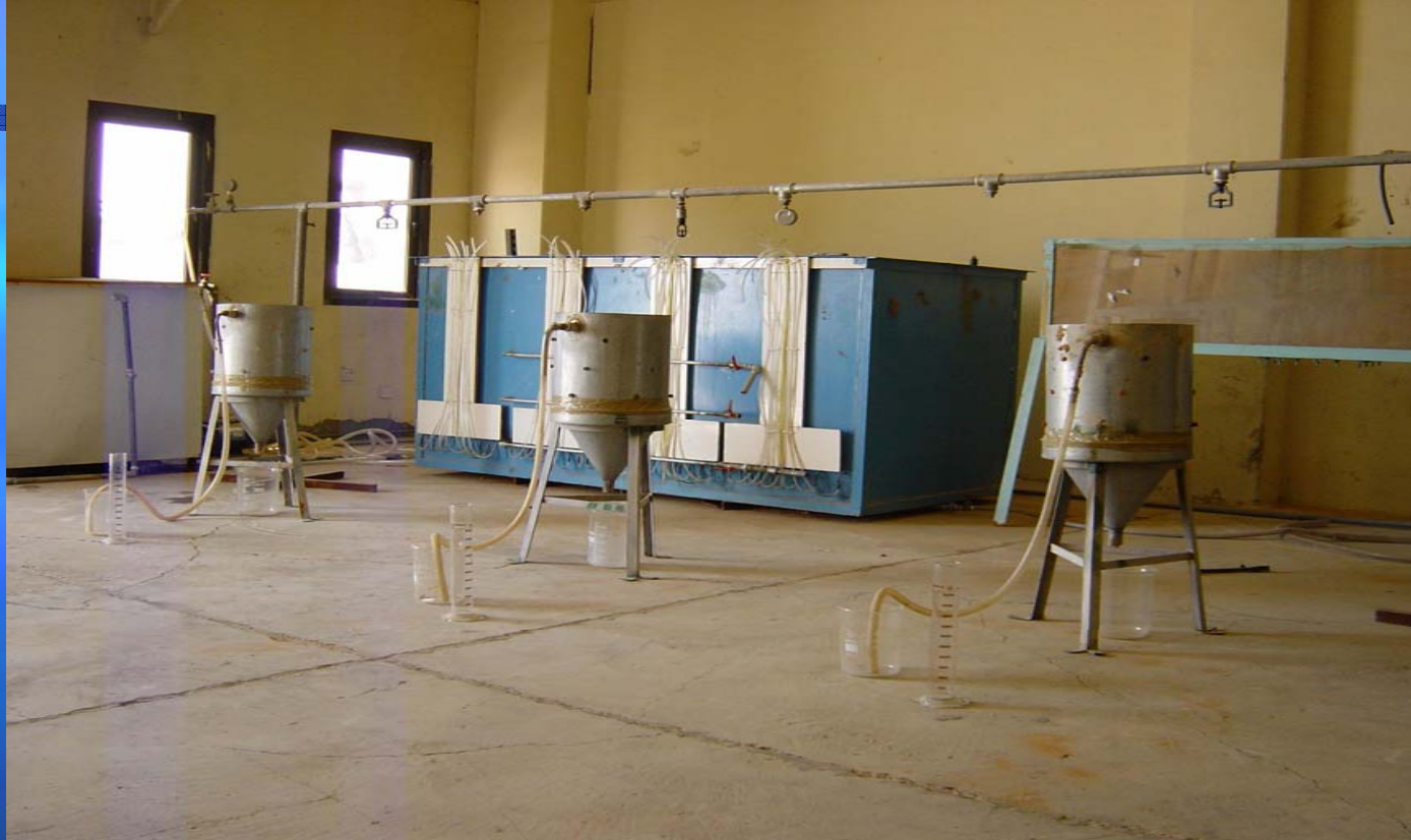
الصورة ٢. جهاز محاكاة المطر المستخدم في تقدير معدل التسرب في معمل الري .
