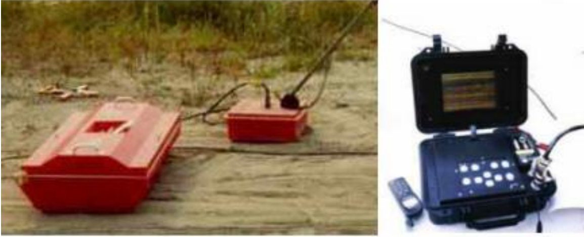
جهاز رادار الأختراق الأرضي لأغراض الكشف عن الفجوات تحت سطحية ودراسة التراكيب الجيولوجية الضحلة
