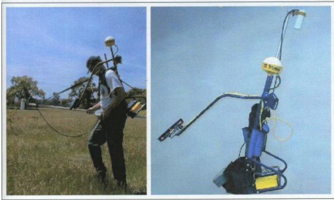
جهاز قياس المجال المغناطيسي الأرضي لأغراض البحث عن المعادن ودراسة التراكيب الجيولوجية لصخور القاعدة
