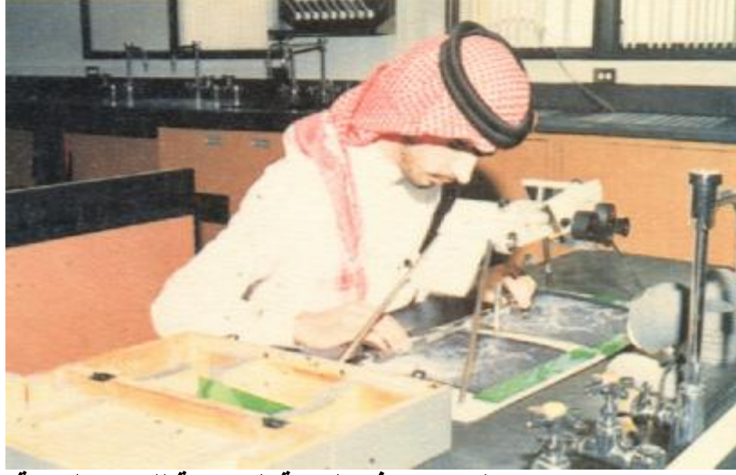
جهاز الاستريوسكوب المستخدم في الرؤية المجسمة للصور الجوية
