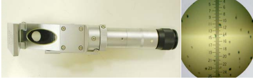
شكل ٢: جهاز رفرأكتوميتر حقلي أو جيبى Traditional handheld refractometer
