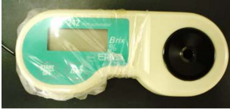
شكل ٣: جهاز رقمى لقياس TSS Digital handheld refractometer
